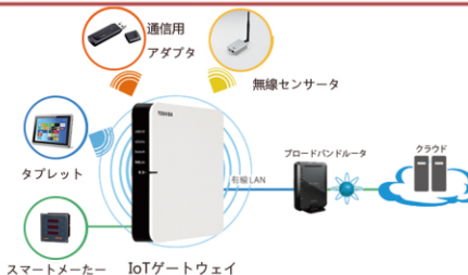
センサーデータをホームゲートウェイを経由し、クラウドへアップロード クラウドでデータを保存・分析
